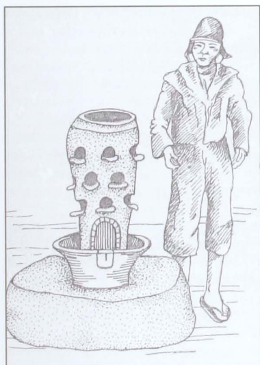
Figura 4. La huayra fue el horno de fundición más sofisticado desarrollado en los Andes. Operaba captando los vientos a través de perforaciones distribuidas en su cuerpo. En la ilustración, una huayra con su operario, según un registro realizado a fines del siglo XIX, en Bolivia.
